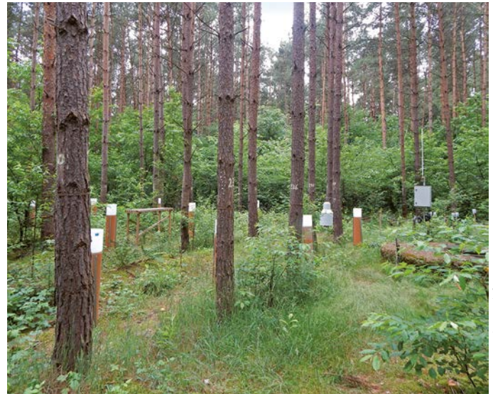
Messung der atmosphärischen Stoffeinträge auf dem Großlysimeter Colbitz
