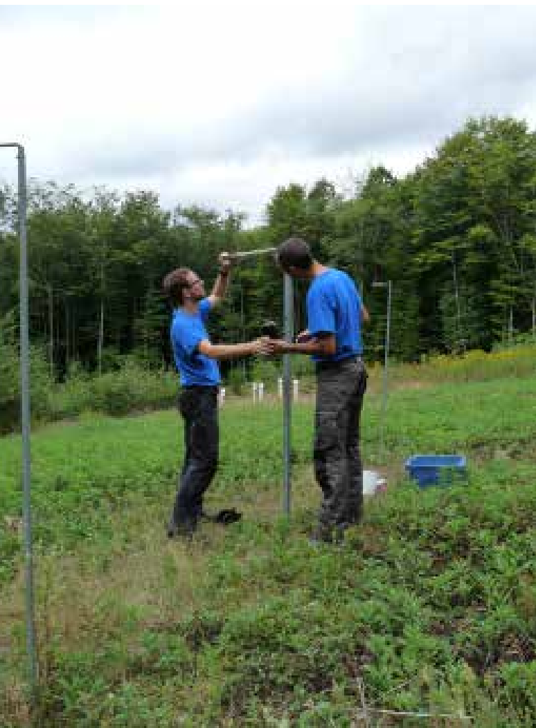
Passivsammlersystem zum Messen von Luftschadstoffen an der Level-II-Fläche Fischbach, Foto: D. Hemmerling
