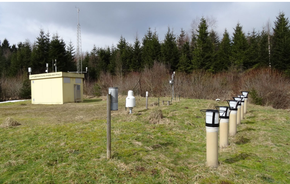
Messstation in der Westeifel bei Wascheid, für Witterungsverlauf, Luftschadstoffkonzentration und Stoffeintrag; Foto: Mike Brando
