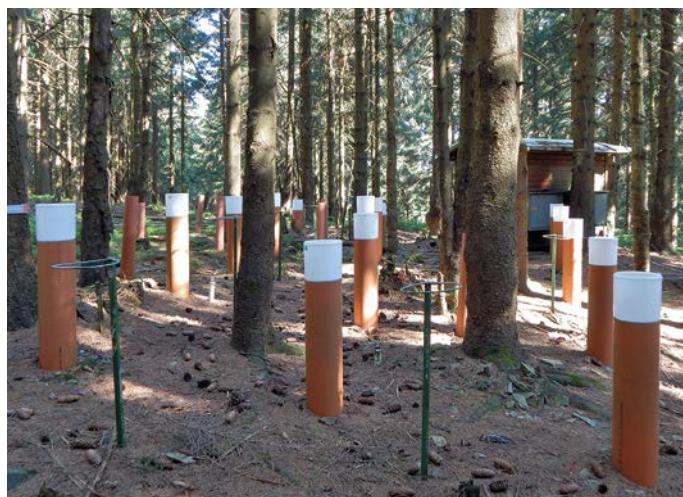
Erfassung des Bestandesniederschlages auf einer Intensiv-Monitoringfläche
