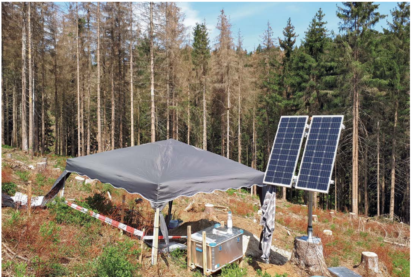
Einbau von Lysimetern zur Untersuchung der Bodenlösung auf dem nach Borkenkäferbefall geräumten Teil der Fläche Lange Bramke Nordhang
