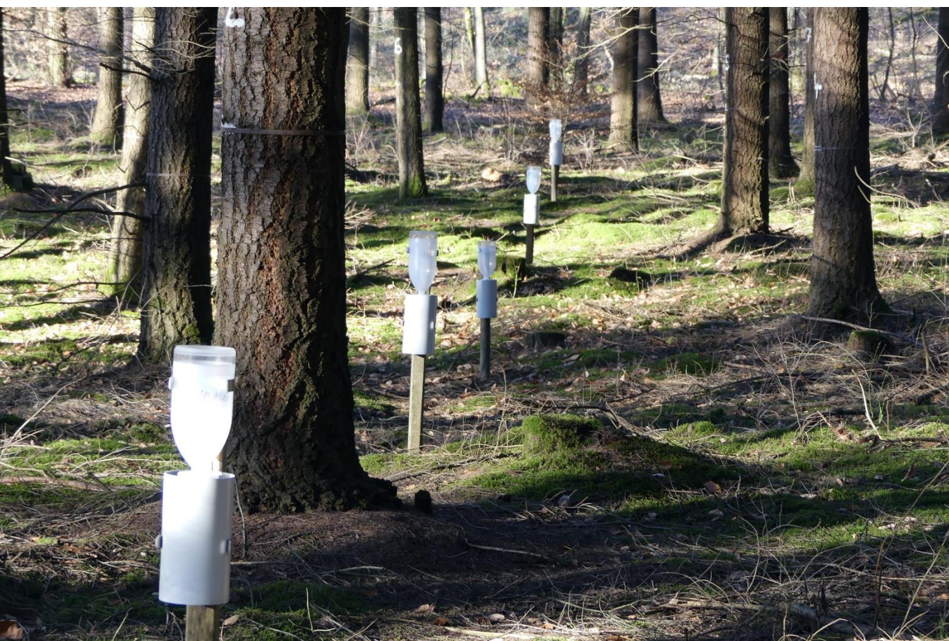
Abb. 20: Messung des Bestandesniederschlags auf der Douglasien-Versuchsfläche in Hockenheim (Foto: S. Meining).
