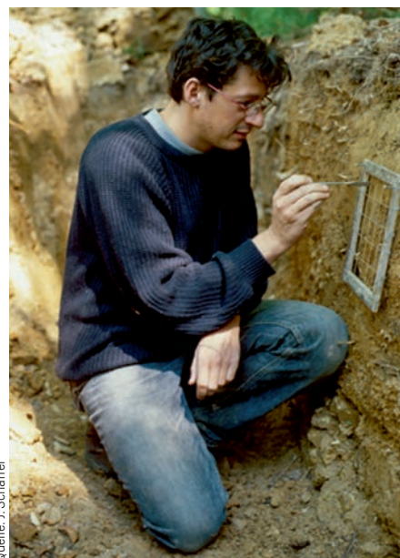
Abb. 4: Der langfristige Kalkungsversuch Ulm zeigt auf der 1952 mit 10 t/ha gekalkten Parzelle einen etwa doppelt so tiefen Hauptwurzelraum wie auf der ungekalkten Kontrollparzelle (rechts). Zählung der Feinwurzeln mit einem Zählrahmen (links) [12]
