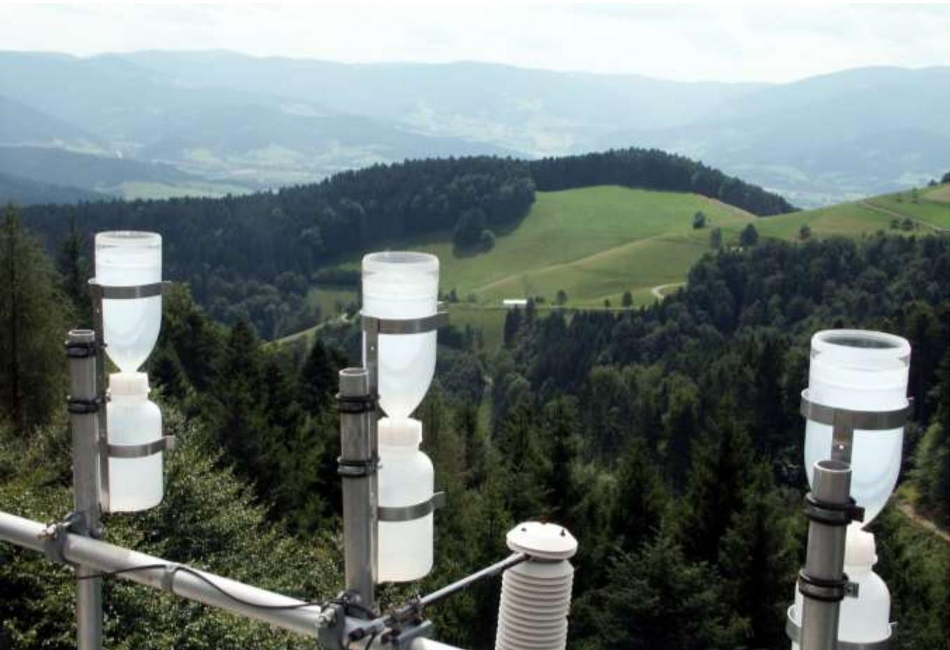
**Abb. 61:** Auffangbehälter zur Messung der Freilanddeposition; Messturm Conventwald (Foto: A. Hölscher)
