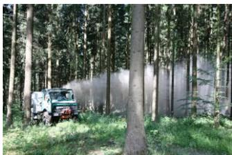
*BU: Ein Spezialfahrzeug verteilt Kalkpulver zur Verbesserung der Bodenqualität.
